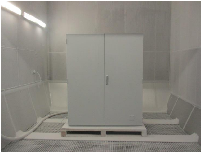
Abb. 2 Prüfling in der Staubkammer nach der Staubprüfung (IP6X)
