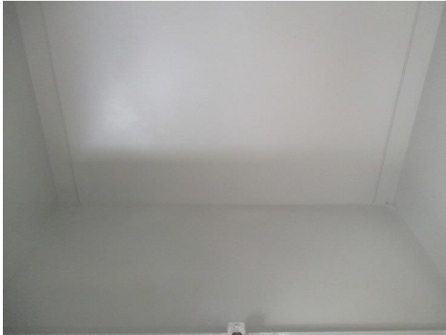
Abb. 4 nach der Wasserprüfung: kein Wasser in das Gehäuse eingedrungen
