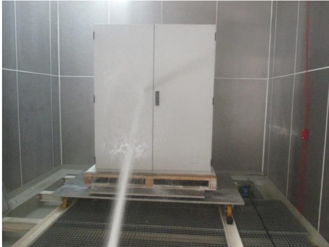
Abb. 3 Prüfaufbau für die Wasserprüfung (IPX6)
