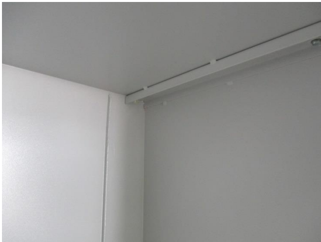
Abb. 8 nach der Staubprüfung: kein Staub in das Gehäuse eingedrungen
