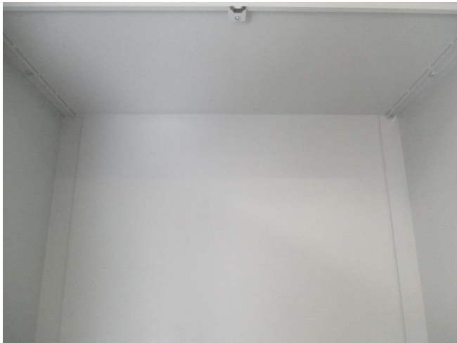
Abb. 5 nach der Wasserprüfung: kein Wasser in das Gehäuse eingedrungen
