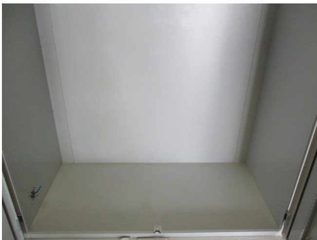
Abb. 6 nach der Staubprüfung: kein Staub in das Gehäuse eingedrungen
